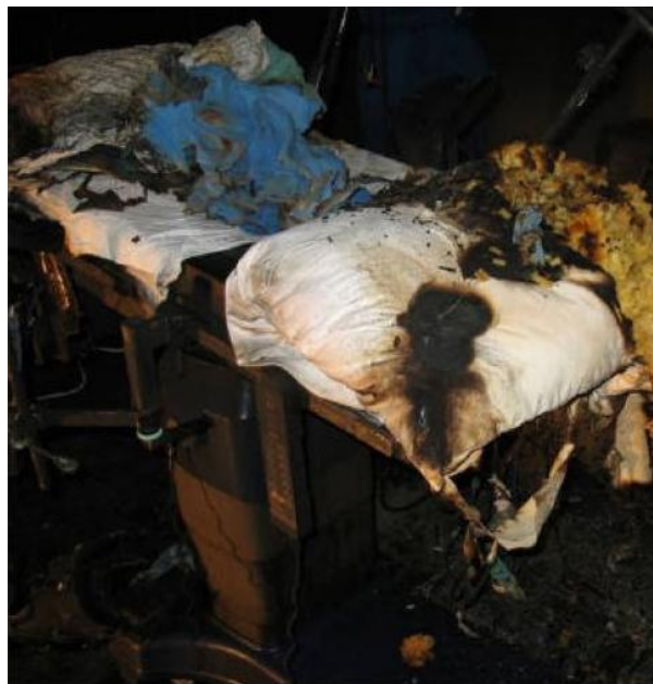
Afb. 5.2 De operatietafel na de brand. De afstandbediening waarmee de tafel verrijdbaar kan worden gemaakt, was niet meer bereikbaar. Bron: Onderzoeksraad (2006).
