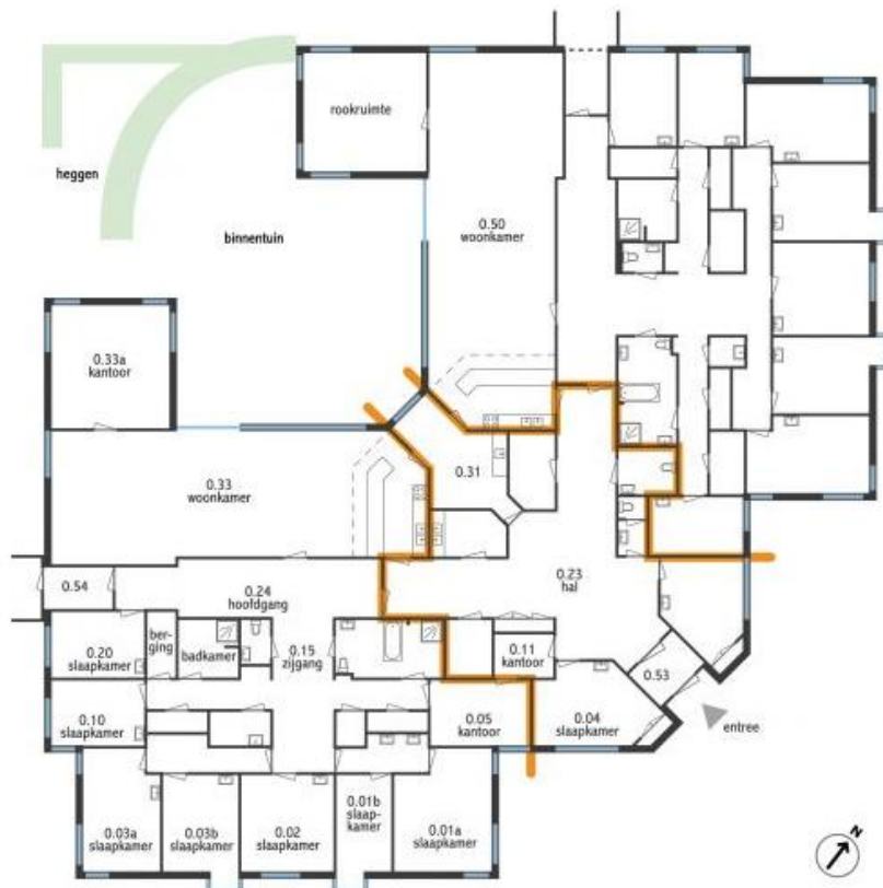
Afb. 5.4 De brandcompartimentering van het gebouw. Bron: Onderzoeksraad (2011).
