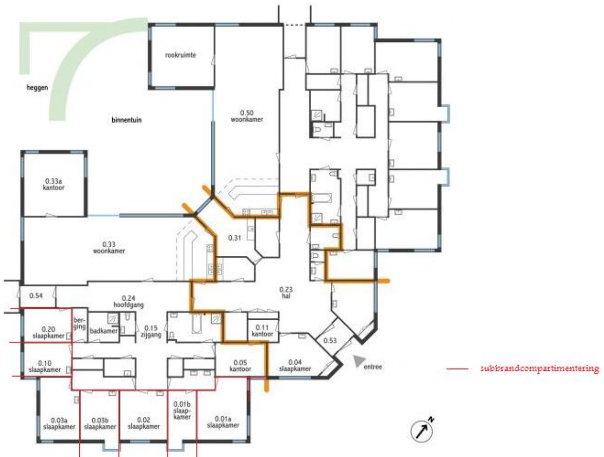
Afb. 6.1 De subbrandcompartimentering volgens de bestaande bouw eisen voor een gezondheidszorgfunctie uit het Bouwbesluit 2003. Bron: Onderzoeksraad (2011) met eigen aanpassingen.
