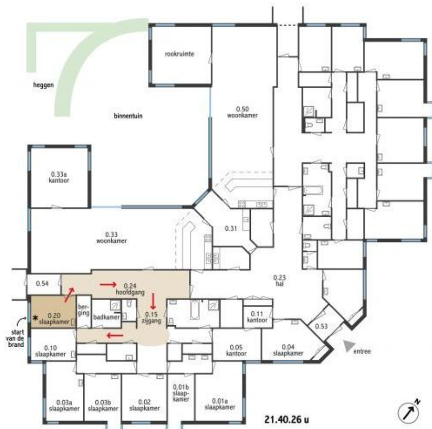
Afb. 5.6 De verspreiding van de brand en de rook vanaf de brandhaard. Bron: Onderzoeksraad (2011).
